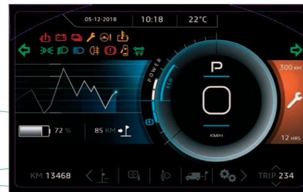
LCD HD displej, který u nového modelu G6 hraje zásadní roli, umožňuje sledovat spotřebu elektrické energie v reálném čase a umožňuje přístup ke klíčovým funkcím vozidla (ovládání elektrické brzdy, LED reflektorů, bočních zrcátek...).
