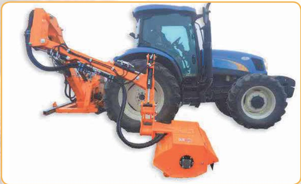
**IT** Braccio decespugliatore con sistema di avanzamento idraulico della testata che ne migliora la visibilità e la facilità di uso. È adatto ai professionisti più esigenti e viene abbinato a trattori con minimo 130 HP.
