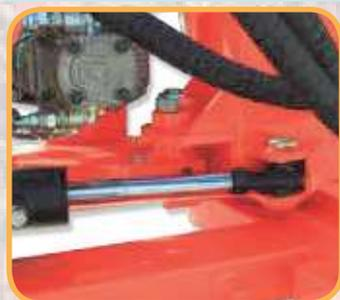
Snodo idraulico di sicurezza e rotazione a 90°
