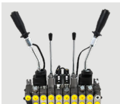
Mechanický pákový rozvaděč s el. funkcemi 2 funkce XY, 2 přímé funkce a 2 funkce elektrického zapnutí / vypnutí s elektrickými tlačítky na pákách.
