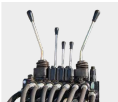
Mechanický vícepákový rozvaděč 2 funkce XY a zbývající přímé funkce.
