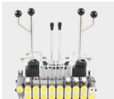
Blok mechanických ventilů Dvojité páky „sobí rohy“ se 2 funkcemi XYZ a dvěma přímými funkcemi.
