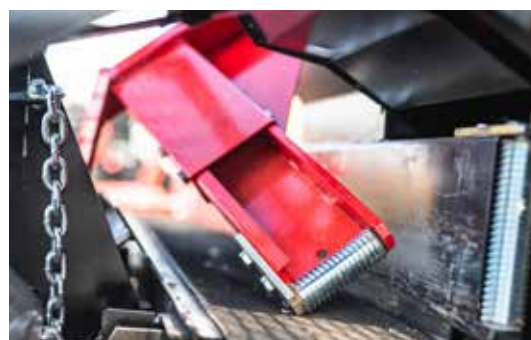
Modely Pro a Pro+: Hydraulické upínání kulatiny je automatizované a zlepšuje ovládání kulatiny.
