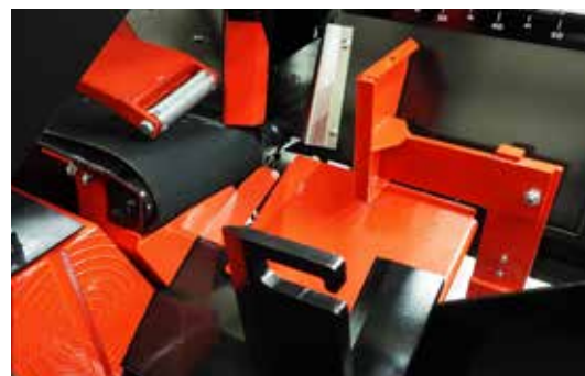
Padací deska navádí dřevo přímo do štípacího skluzu.
