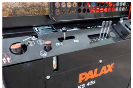
Všechny ovládací páky jsou smontovány na jednom místě, čímž umožňují snadnou obsluhu.
