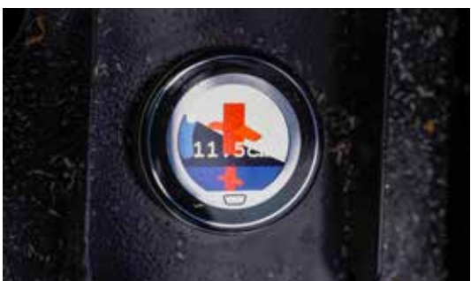
S funkcí X-Aim je štípaní automatizované a výsledkem je vysoce kvalitní palivové dřevo i přes různé průměry vstupní kulatiny.
