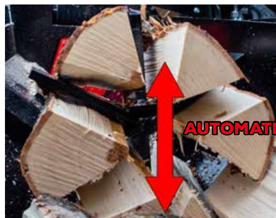
X-Aim automaticky upraví štípací klín na optimální výšku uprostřed kulatiny.
