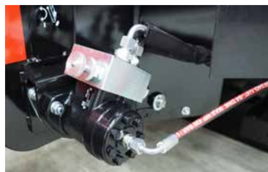
Podavačí dopravník nabízí plynulou regulaci rychlosti.
