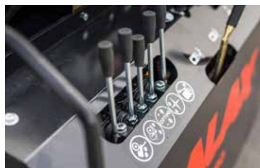
Všechny ovládací páky jsou smontovány na jednom místě, čímž umožňují snadnou obsluhu.
