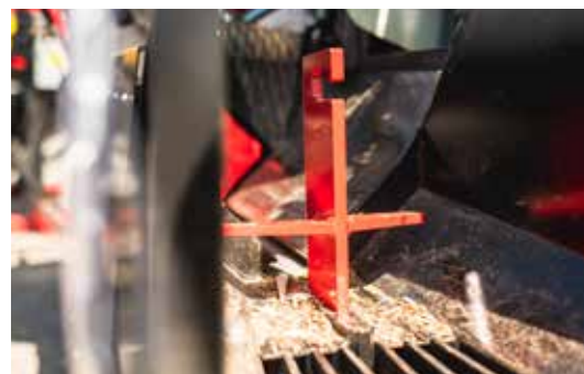
Nastavitelný štípací klín je snadno vyměnitelný.
