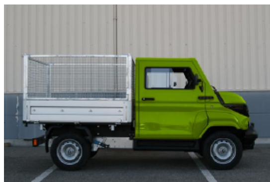
E10 – klecová nástavba
